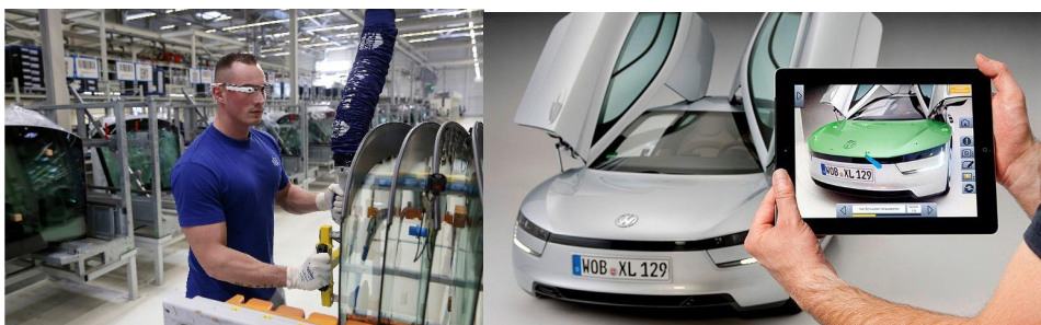
ILUSTRACIÓN 39: IZQ- USO DE GAFAS INTELIGENTES PARA LAS OPERACIONES DE MONTAJE; DCHA - SISTEMA MARTA DE SOPORTE A LAS OPERACIONES DE MANTENIMIENTO Y REPARACIÓN. FUNET: VOLKSWAGEN
