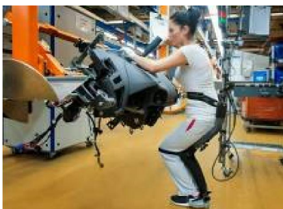
ILUSTRACIÓN 48: APLICACIÓN EXOSQUELETO CHAIRLESS CHAIR EN AUTOMOCIÓN. FUENTE: AUDI MEDIA GROUP
