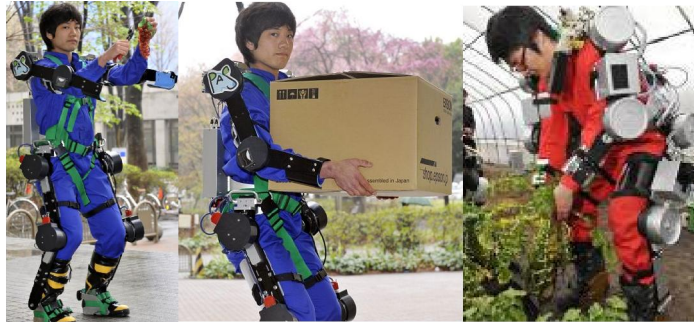
ILUSTRACIÓN 52. EXOESQUELETO ROBO-SUIT EMPLEADO EN AGRICULTURA. FUENTE: ROBO-HUB.ORG
