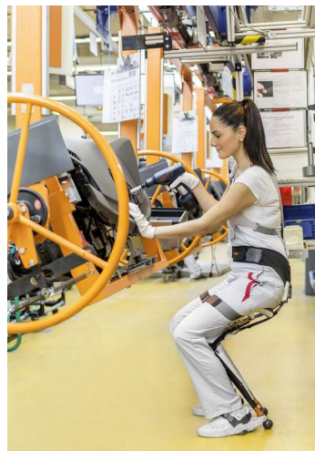
ILUSTRACIÓN 23: EJEMPLO DE EXOESQUELETO DE PARTE INFERIOR (PROTOTIPO AUDI). FUENTE: AUDI MEDIA CENTER
