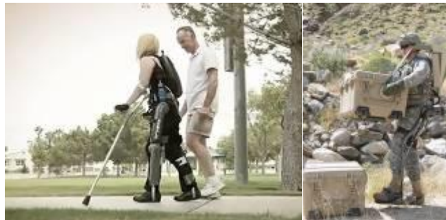
ILUSTRACIÓN 25: APLICACIONES DE EXOESQUELETOS EN REHABILITACIÓN (EXOESQUELETO ARGO) Y EN APLICACIONES MILITARES (EXOESQUELETO HULC). FUENTE: REWALK Y LOCKHEED MARTIN
