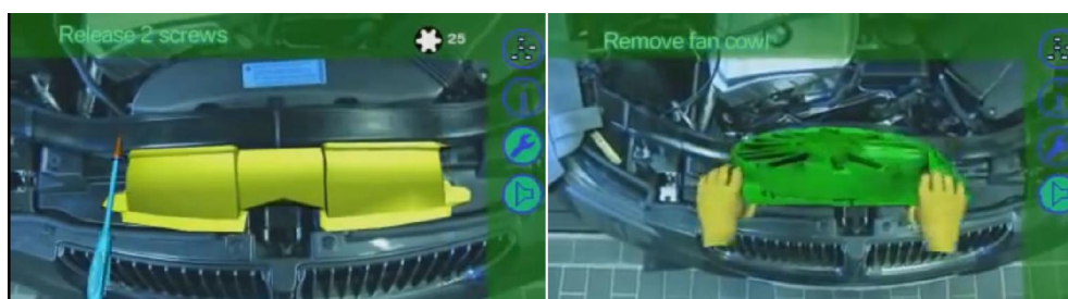
ILUSTRACIÓN 40: APLICACIÓN DE REALIDAD AUMENTADA EN UN TALLER DE REPARACIÓN. FUENTE: BMW
