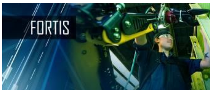
ILUSTRACIÓN 28: EXOESQUELETO FORTIS PARA LA MANIPULACIÓN DE HERRAMIENTAS PESADAS EN ENTORNOS INDUSTRIALES. FUENTE: LOCKHEED MARTIN.
