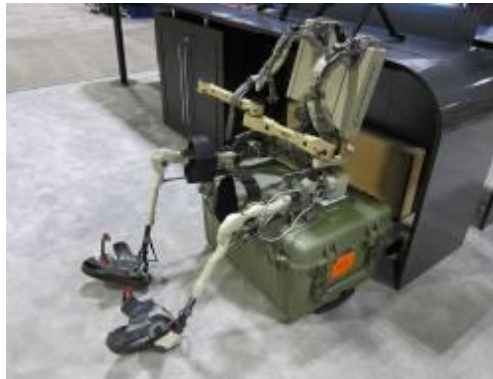
ILUSTRACIÓN 24: EJEMPLO DE EXOESQUELETO ANTROPOMÓRFICO HULC. FUENTE: LOCKHEED MARTIN
