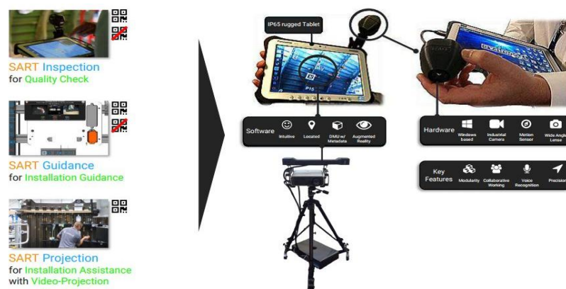
ILUSTRACIÓN 43: HARDWARE Y SOFTWARE DEL SISTEMA MIRA DE AIRBUS. FUENTE: AIRBUS
