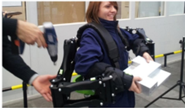
ILUSTRACIÓN 50: PRUEBAS CON EXOESQUELETO DE ESPALDA EN AIRBUS. FUENTE: AIRBUS GROUP 63
