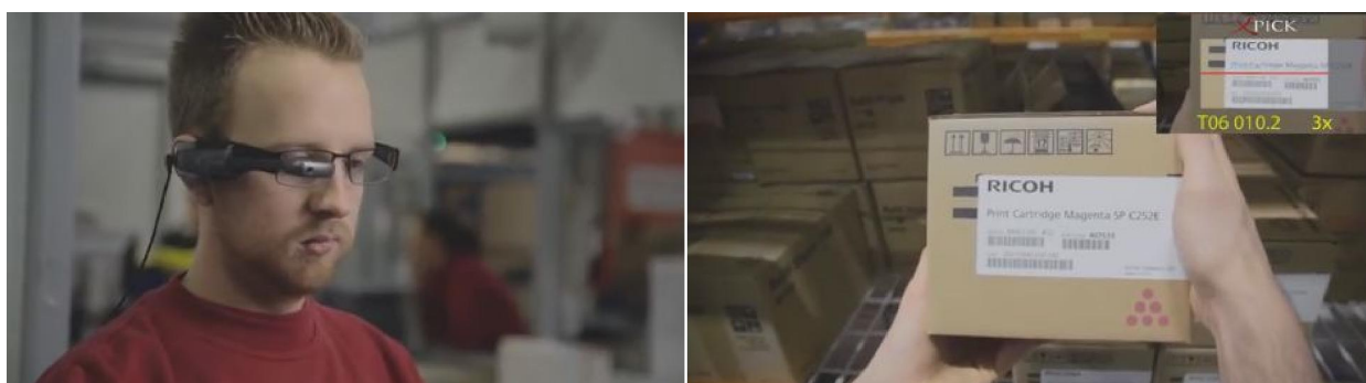
ILUSTRACIÓN 41: SISTEMA DE PICKING CON GAFAS DE REALIDAD AUMENTADA. FUENTE: DHL
