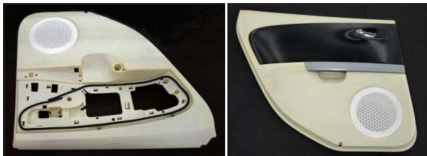
**ILUSTRACIÓN 38. PROTOTIPO DE CONJUNTO PANEL DE PUERTA TRASERO DE SEAT ALTEA. FUENTE: AITIIP**
