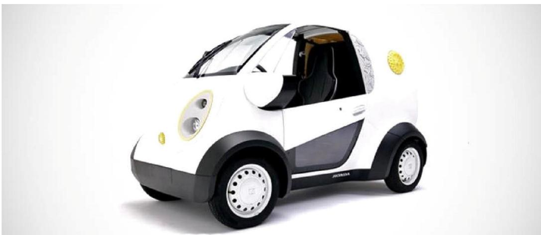
ILUSTRACIÓN 21. PROTOTIPO DE MINIFURGONETA DE REPARTO HONDA, CUYA CARROCERÍA HA SIDO FABRICADA MEDIANTE IMPRESIÓN 3D
