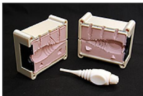
ILUSTRACIÓN 59. MOLDES DE SILICONA CON MODELOS REALIZADOS CON FDM. FUENTE: STRATASYS
