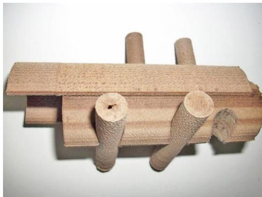
ILUSTRACIÓN 55. EJEMPLOS DE PIEZAS FABRICADAS MEDIANTE FA EN MADERA
