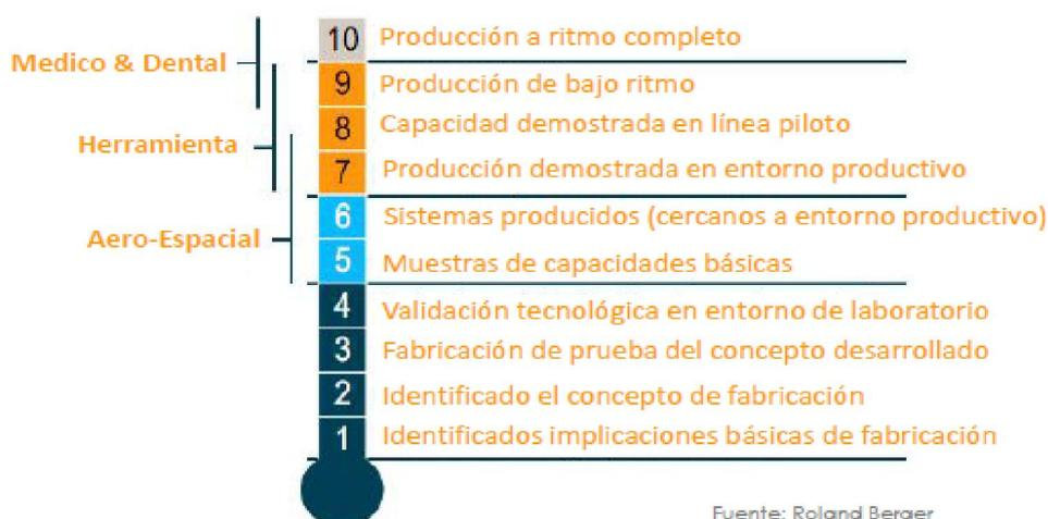
ILUSTRACIÓN 3. NIVELES DE APLICACIÓN DE LA FABRICACIÓN ADITIVA POR SECTORES
