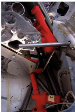
**ILUSTRACIÓN 66. MODELO SUSTITUTO DE COLOR ROJO QUE SIMULA EL ESPACIO A OCUPAR POR CONDUCTOS ELÉCTRICOS EN EL CHASIS DE UN OSPREY (HÍBRIDO ENTRE HELICÓPTERO Y AVIÓN). FUENTE: STRATASYS**
