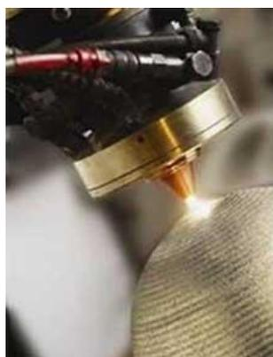
ILUSTRACIÓN 9. PIEZA FABRICADA POR CAPAS MEDIANTE LASER CLADDING
