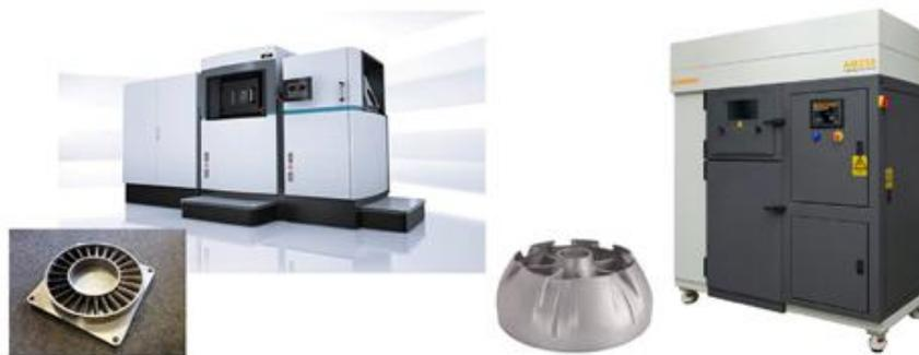
**ILUSTRACIÓN 5. EJEMPLOS DE MÁQUINAS DE FA EN MATERIALES METÁLICOS Y PIEZAS OBTENIDAS**
