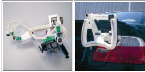
**ILUSTRACIÓN 35. HERRAMIENTA PARA COLOCACIÓN DEL PARACHOQUES CON FDM. FUENTE: STRATASYS**
