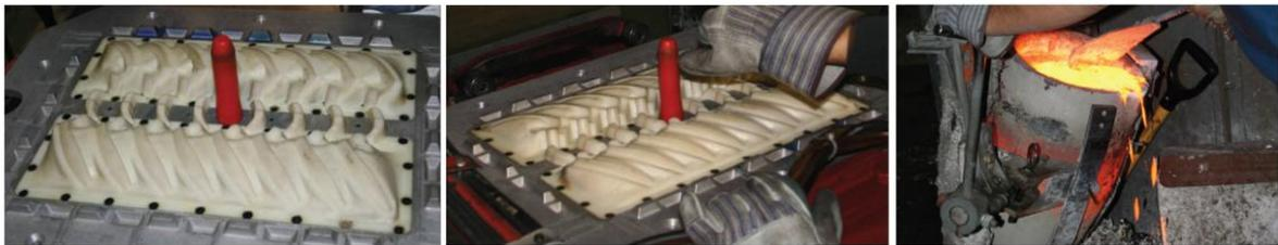
**ILUSTRACIÓN 60. MOLDEO EN ARENA “MATCHPLATE” CON INSERTO EN FDM (BLANCO). FUENTE: STRATASYS**
