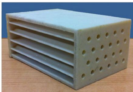
**ILUSTRACIÓN 63. INTERCAMBIADOR DE CALOR FABRICADO CON TECNOLOGÍA FDM. FUENTE: SCHOOL OF ENGINEERING**
