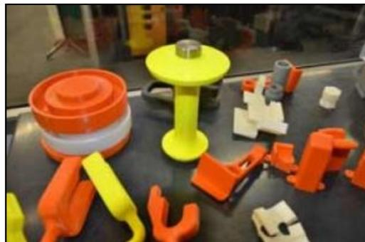
**ILUSTRACIÓN 36. HERRAMIENTAS DE MONTAJE REALIZADAS CON IMPRESIÓN 3D. FUENTE: STRATASYS**
