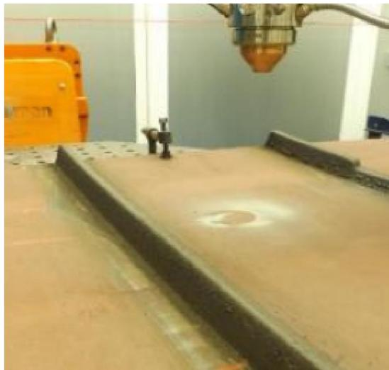
**ILUSTRACIÓN 27. REFUERZO NAVAL FABRICADO POR LÁSER CLADDING**
