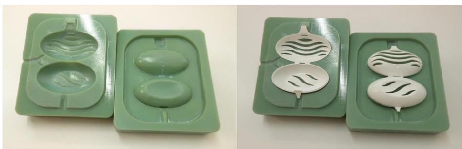
**ILUSTRACIÓN 62. MOLDE DE INYECCIÓN IMPRESO EN DIGITAL ABS CON POLYJET PARA PROTOTIPO DE BLOQUE DESINFECTANTE DOMESTOS (UNILEVER). FUENTE: COMHER**
