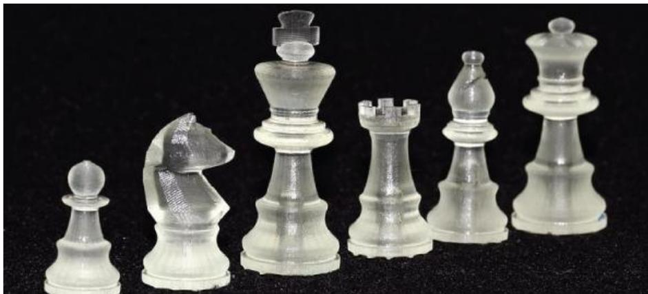
ILUSTRACIÓN 11. PIEZAS DE AJEDREZ FABRICADAS MEDIANTE SLA
