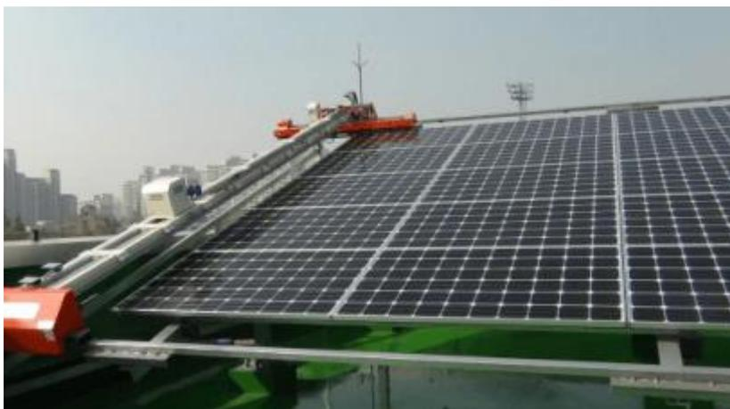
**ILUSTRACIÓN 41: ROBOT PARA LIMPIEZA DE PANELES SOLARES. FUENTE: KICT.**
