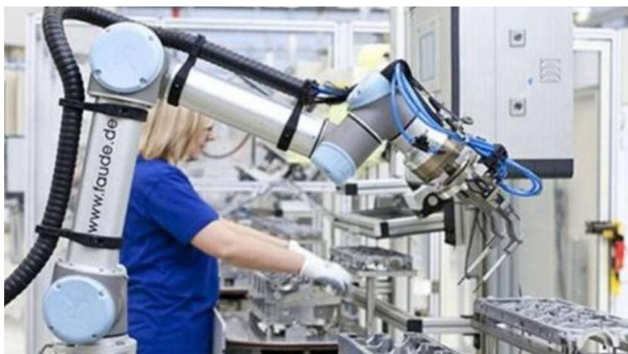
ILUSTRACIÓN 38: ROBOT COLABORATIVO O COBOT AYUDANDO A UNA OPERARIA
