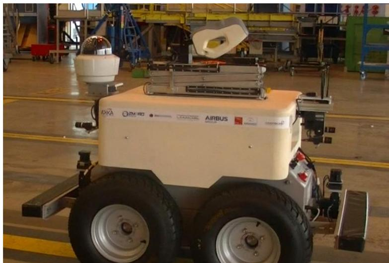
**ILUSTRACIÓN 31: AIR-COBOT, AIRCRAFT ENHANCED INSPECTION BY SMART & COLLABORATIVE ROBOT**
