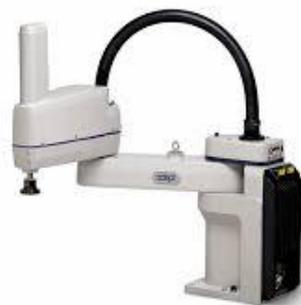
ILUSTRACIÓN 25: ROBOT TIPO SCARA
