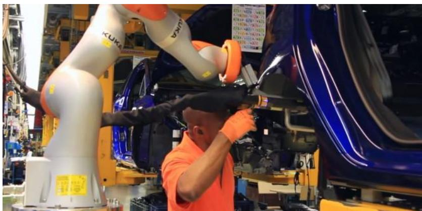
**ILUSTRACIÓN 39: COBOT COLABORANDO CON UN OPERARIO EN LA PLANTA ALEMANA DE COLONIA DE FORD.
