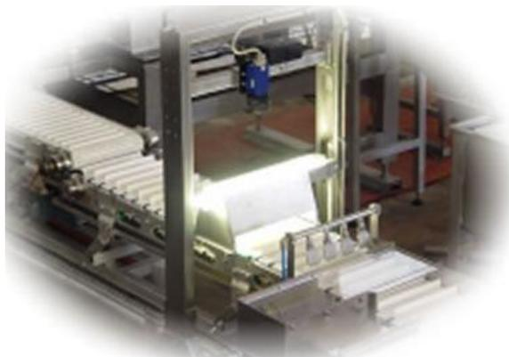
ILUSTRACIÓN 34: EQUIPO DE CLASIFICACIÓN DE PELÁGICOS PARA INDUSTRIA CONSERVERA MEDIANTE VISIÓN ARTIFICIAL (PROYECTO BLUE FISH)
