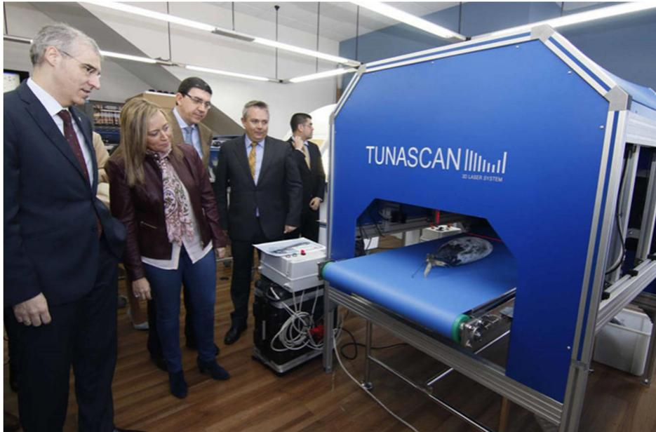
ILUSTRACIÓN 33: EQUIPO TUNASCAN DE CLASIFICACIÓN AUTOMÁTICA DE TÚNIDOS
