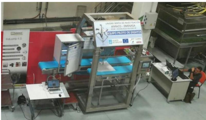
**ILUSTRACIÓN 32: EQUIPO DE VISIÓN ARTIFICIAL + ROBOT DELTA EN LA PLANTA PILOTO DE LA UMI ANFACO-EMENASA**
