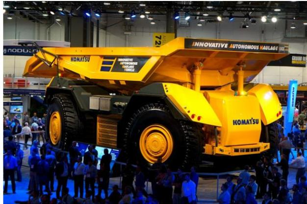
**ILUSTRACIÓN 21: IAHV. DUMPER SIN CONDUCTOR.** <https://www.xataka.com/vehiculos/este-camion-es-del-tamano-de-una-casa-y-no-tiene-ni-necesita-conductor>
