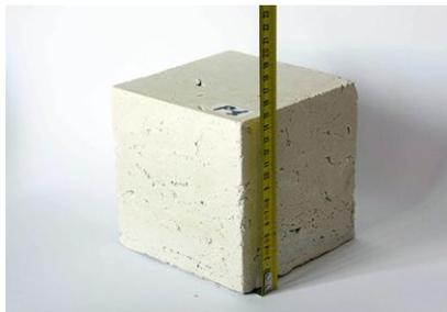
**ILUSTRACIÓN 17: BLOQUE DE PIEDRA CREADO A PARTIR DE LODOS DE MÁRMOL CON LA IMPRESORA ED. TRIP3DPRINTER. FUENTE: [www.focuspedra.com](http://www.focuspedra.com)**
