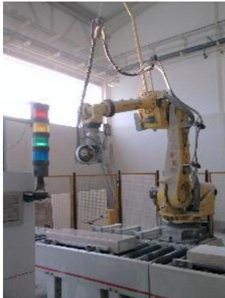
ILUSTRACIÓN 11: ROBOT FACNUC R-2000IB. FUENTE: <http://www.digafer.es>
