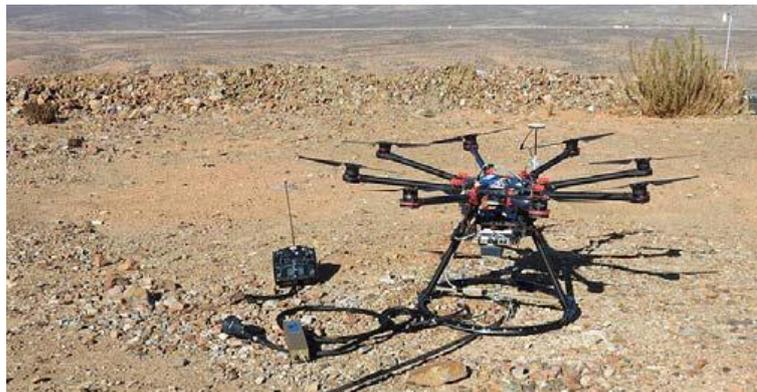
**ILUSTRACIÓN 18: EJEMPLO DE DRONE UTILIZADO PARA EXPLORACIÓN MINERA. FUENTE: GEOMAGDRONE**
